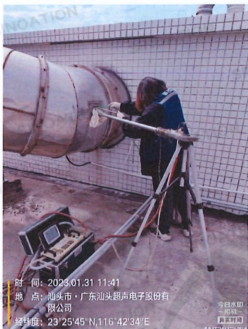
有机废气 (FQ-16324) (处理前)
